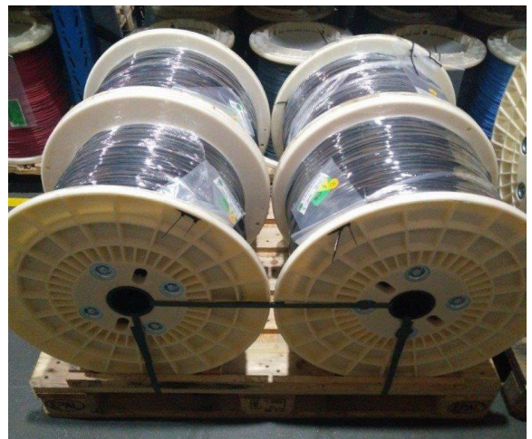
Abb. 8: Trommel stehend auf Flansch platzieren
